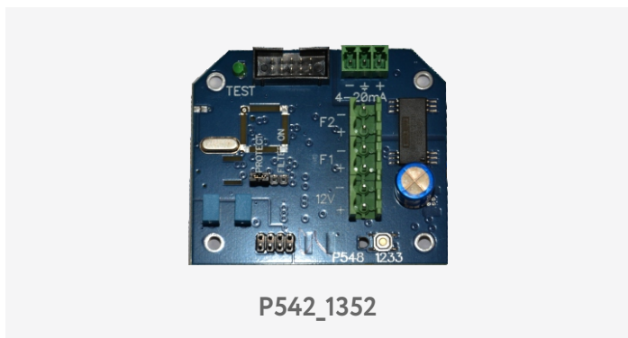
Рис. 2.1 Внешний вид платы блока электронного преобразователя в двух исполнениях.
