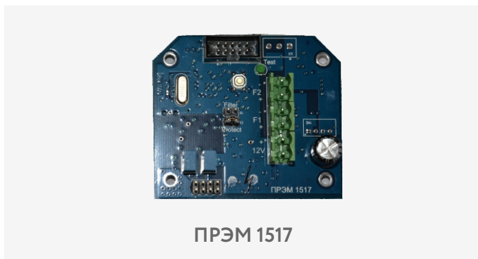
Рис. 2.1 Внешний вид платы блока электронного преобразователя в двух исполнениях.
