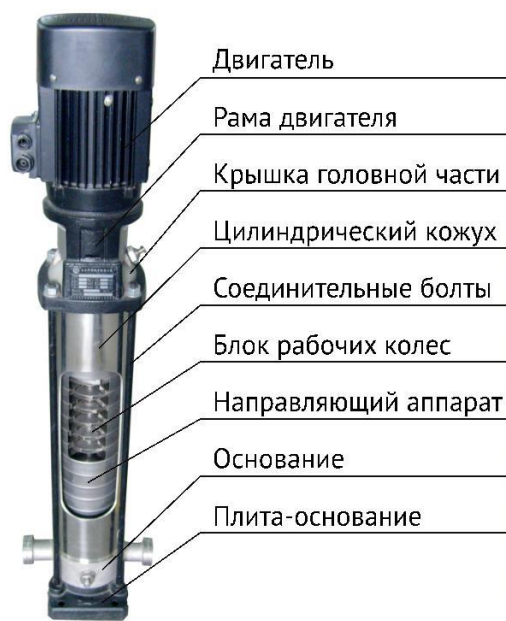
Рис.2. Конструкция насосов
